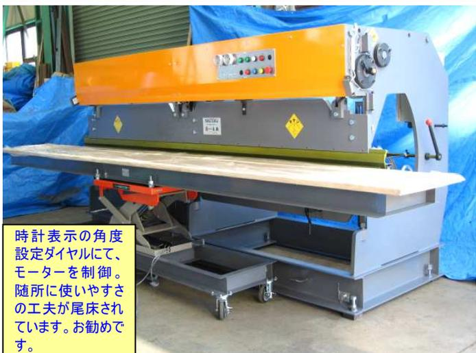
時計表示の角度設定ダイヤルにて、モーターを制御。随所に使いやすさの工夫が尾床されています。お勧めです。
