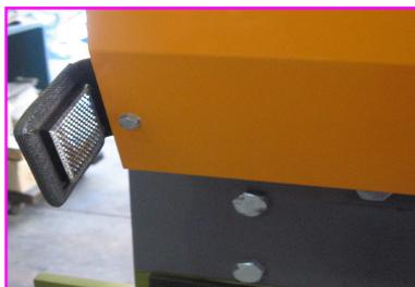
非常停止用センサー 前面パネルをタッチするだけで瞬時停止
